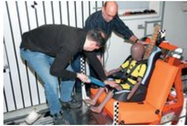
Для имитации реальной слабину внутренних пятиточечных ремешков по правилу ECE R44/04 под спину манекена подкладывают гибкий металлический трос с нанизанными деревянными брусками толщиной 25 мм и шириной 60 мм — и затягивают лямки с усилием 250 Н
