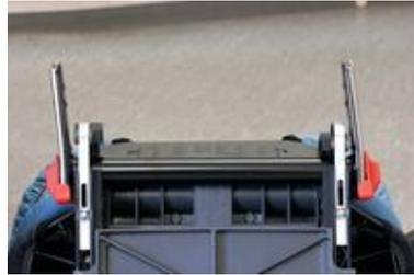
Крепления Isofix хоть и гнутся при боковом ударе, зато снижают нагрузки на ребенка за счет большей стабильности кресла
